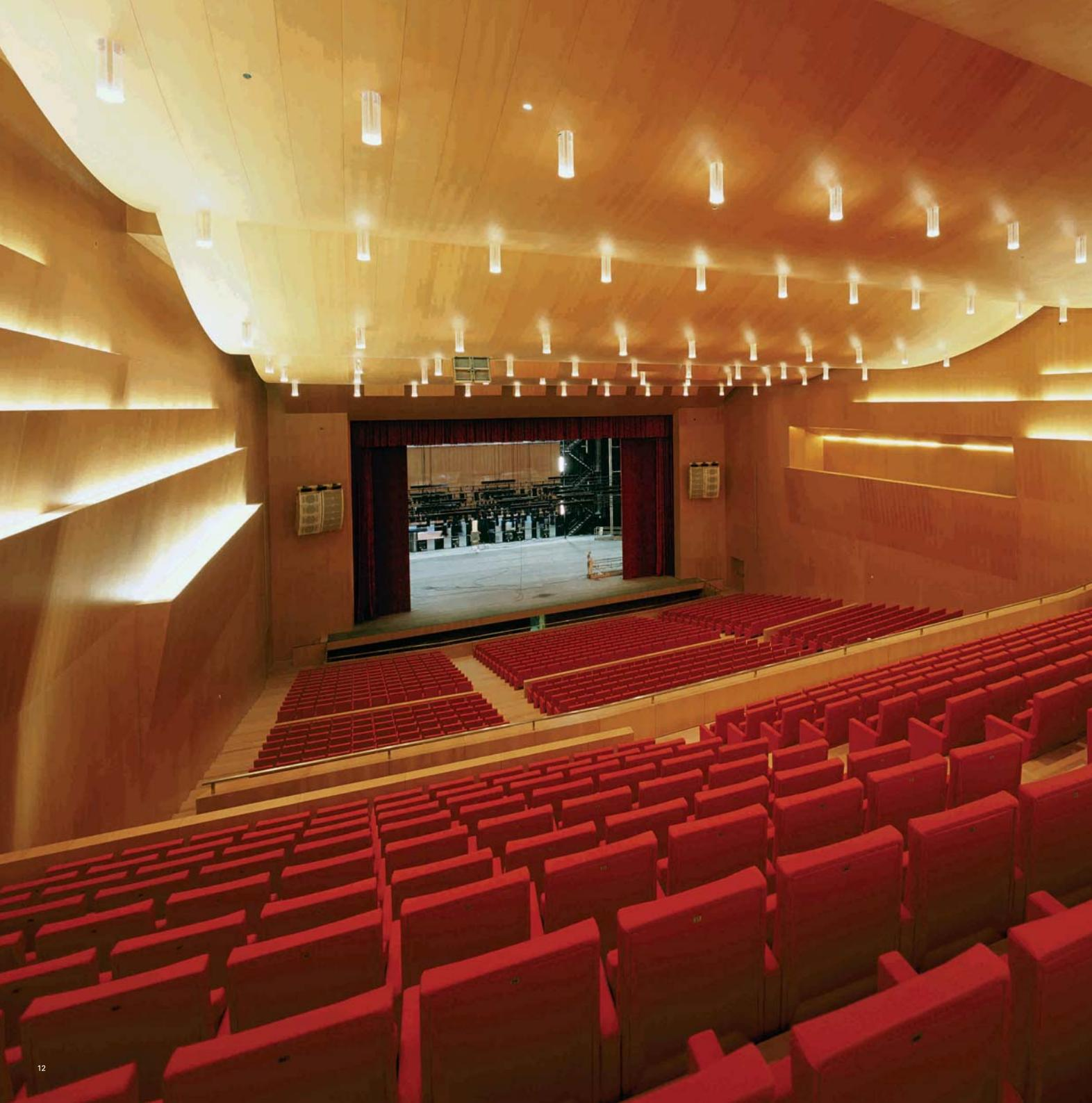
Sumamente confortable, elitista y moderna. Prima la nueva butaca para auditórios y espacios públicos de Dynamobel. Estructura de tubo y chapa de acero soldadas al arco con hilo continuo. Asiento y respaldo de espuma de poliuretano tapizado en piel vacuna o tela de diferentes colores, según muestrario. Inclinación adaptable a las pendientes de las salas. Numeración de butacas personalizable en respaldo. Butacas desmontables para minausválidos y con pala para salas de conferencias.
