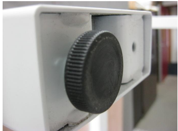
Figuur 10: Beproefd exemplaar 12.0866-2 van Voortman Hi Tee duo open werkplek, slingerverstelbaar- onderaanzicht detail stel poot
