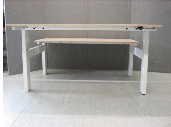
Figuur 2: Beproefd exemplaar 12.0866-2 van Voortman Hi Tee duo open werkplek, slingerverstelbaar- hoogste stand vooraanzicht.
