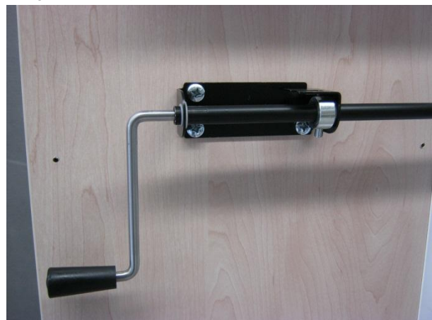
Figuur 6: Beproefd exemplaar 12.0866-2 van Voortman Hi Tee duo open werkplek, slingerverstelbaar- detail hoogte verstelling
